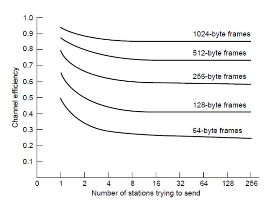
10 Mbps Ethernet, 64 byte min. frame
